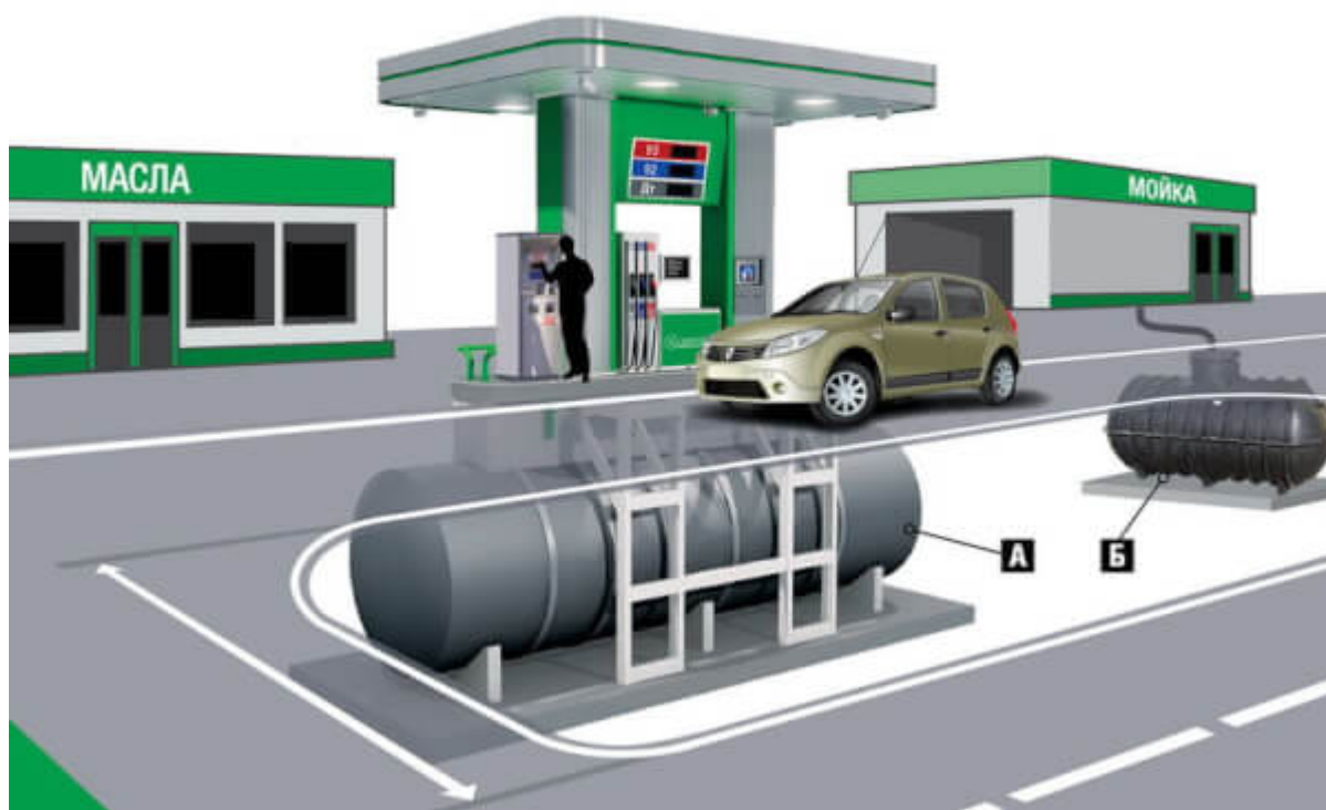
Рис. 1 – Подземный резервуар для топлива
